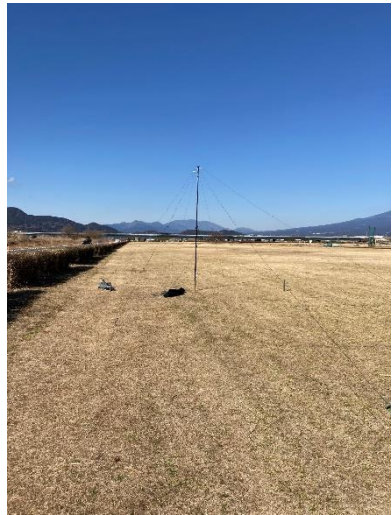
マストを立て各エレメント をステーの様に展開
